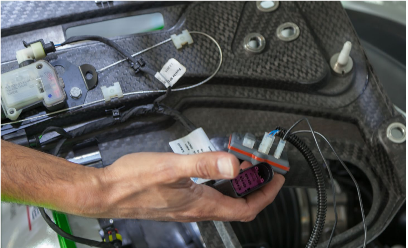
8. Die Steuerung kann an dem OEM Kabelbaum (hier Panelsteckverbindung) befestigt werden. 8. The controller might be tied to the OEM harness (in this case, the OEM panel plug).
