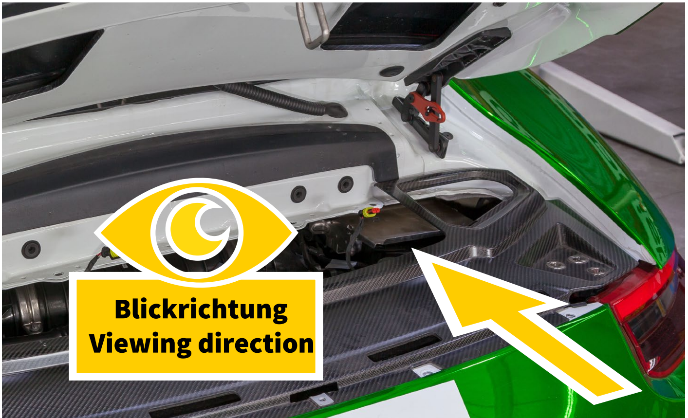
7. Das OEM-Magnetventil befindet sich etwas versteckt, rechts unter der Karosserie. 7. The OEM-solenoid sits on the right hand side hidden beneath the chassis.
