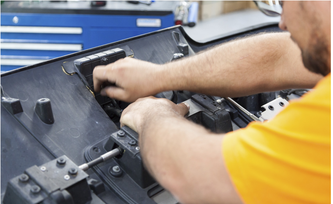
Kamera-Bremslichteinheit demontieren und Kamera ausbauen. / Demount the cam-brake light unit and detach the cam.
