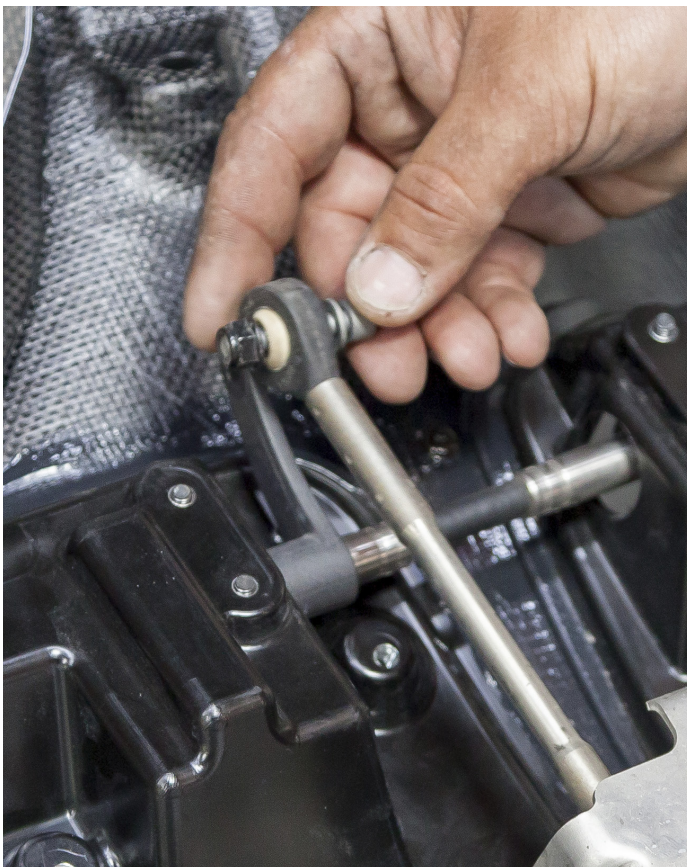
Jetzt kann die Schubstange verbunden werden. / Now the driving rod can be connected.
