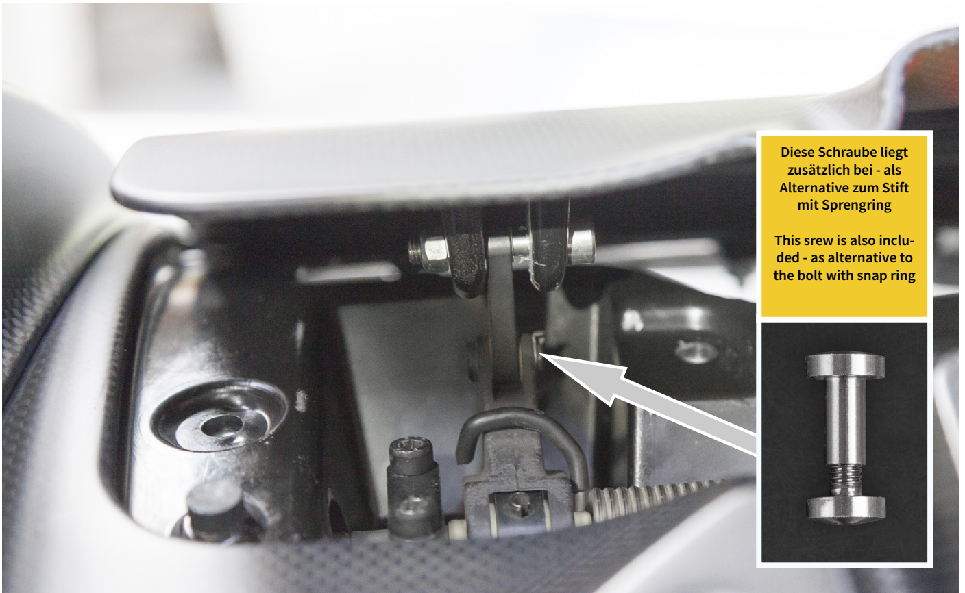
Lasche einer Klappe verbunden mit dem Hebel der Achse. / Lugs of a flap are connected with the crank of the axis.
